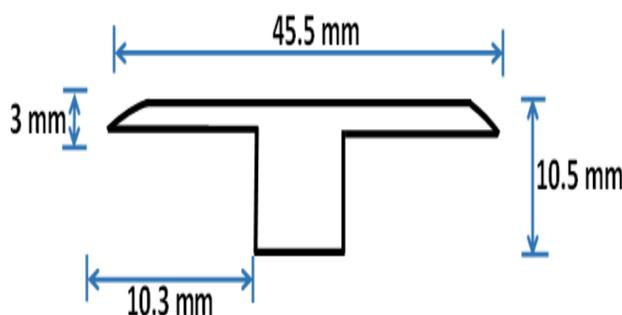
**Remarque :** - Le revêtement de sol stratifié peut être installé dans une seule pièce / zone jusqu'à 36 pieds linéaires de longueur ou de largeur. Les installations dans des pièces / zones de plus de 36 pieds linéaires de longueur ou de largeur doivent utiliser des moulures en T. Dans le cas contraire, la garantie sera annulée.
