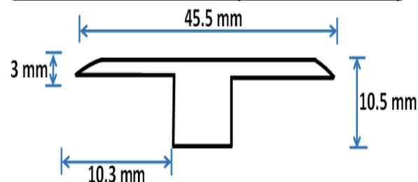
**Remarque** : - Le revêtement de sol stratifié peut être installé dans une seule pièce / zone jusqu'à 36 pieds linéaires de longueur ou de largeur. Les installations dans des pièces / zones de plus de 36 pieds linéaires de longueur ou de largeur doivent utiliser des moulures en T. Dans le cas contraire, la garantie sera annulée.
